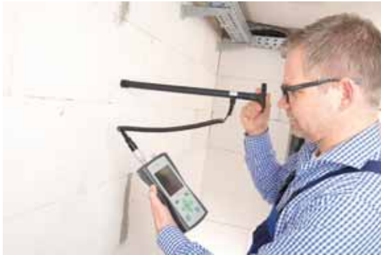
Zubehör für die Leitungsortung Sender mit 2 Sendezangen + Empfänger zum Anschluss an das UM-850 über die Universalschnittstelle
